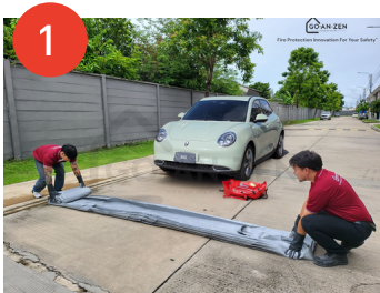
1.นำผ้าคลุมออกจากกระเป่า คลี่ผ้าคลุมออกจากม้วนวางเป็นแนวขวาง ที่ด้านหน้ารถ
