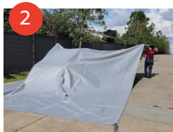
2.จับสายดึงที่มุมผ้าทั้งสองด้าน ยกผ้าขึ้นและเริ่มดึงจากบริเวณด้านหน้ารถ ไปจนถึงท้ายรถที่เกิดไฟไหม้
